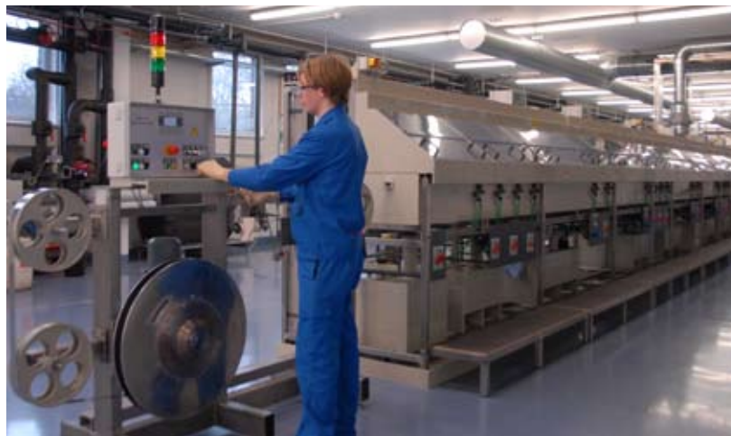
Pilotanlage zur Produktion einer flexiblen, kupferbasierten CIS-Solarzelle
